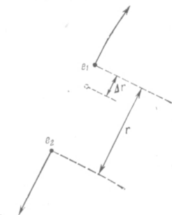
Рис. 4. При смещении заряда e_1 на расстояние \Delta r заряд e_2 «почувствует» изменение силы только через время t_{\text{зап}} = r/c .
